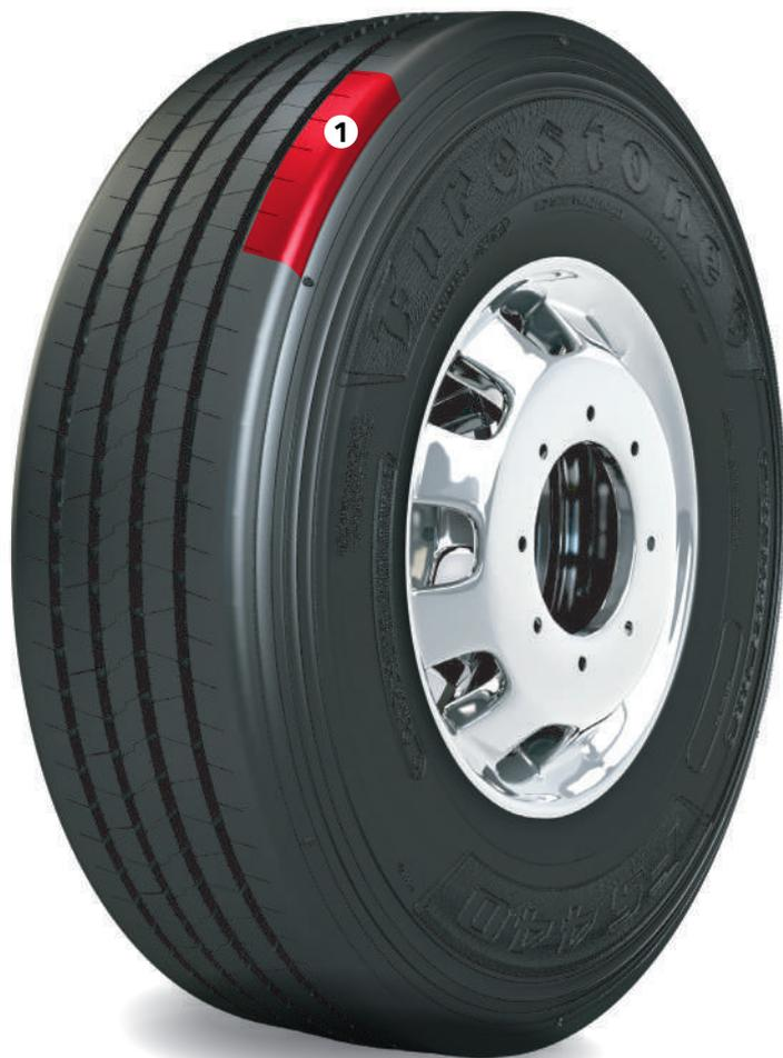
**1 OMBROS ARREDONDADOS: MAIOR RESISTÊNCIA AO ARRASTE LATERAL, EVITANDO ARRANCAMENTO DA RODAGEM PREMATURAMENTE.**
