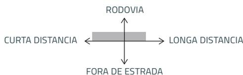
O Firestone FS557 é um pneu radial para aplicação em eixos direcionais, livres e de tração moderada em caminhões e ônibus para uso em rodovias pavimentadas de curta e média distância.
